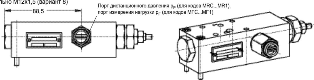
Регуляторы с кодами ...MRC и MFC не имеют монтажной поверхности для клапана на верхней стороне (как показано выше)
