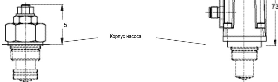
**Размеры для регуляторов с разгрузочным клапаном, коды ...M\*W**
