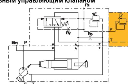
**Дистанционный регулятор давления без встроенного управляющего клапана**
