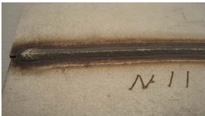
Рис. 34. Внешний вид шва, выполненного АРДС с некачественной защитой от воздуха при сварке
