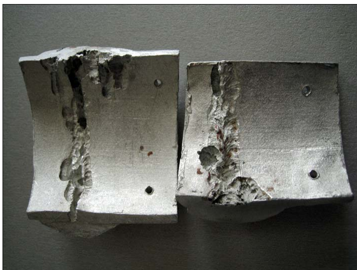
Рис. 8. Сварные соединения, поражённые ножевой и щелевой коррозией
