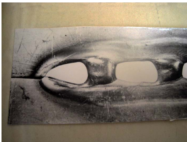
Рис. 47. Прожоги при аргонодуговой сварке тонких листов [10]
